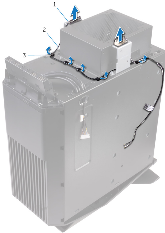
圖 36. 卸下天線纜線
